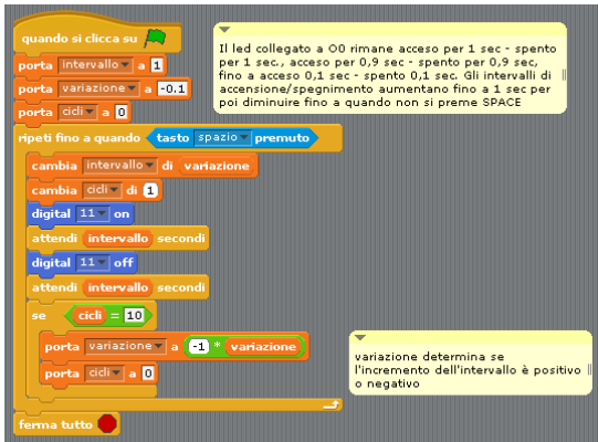
Blink a frequenza variabile di un led collegato a O0
